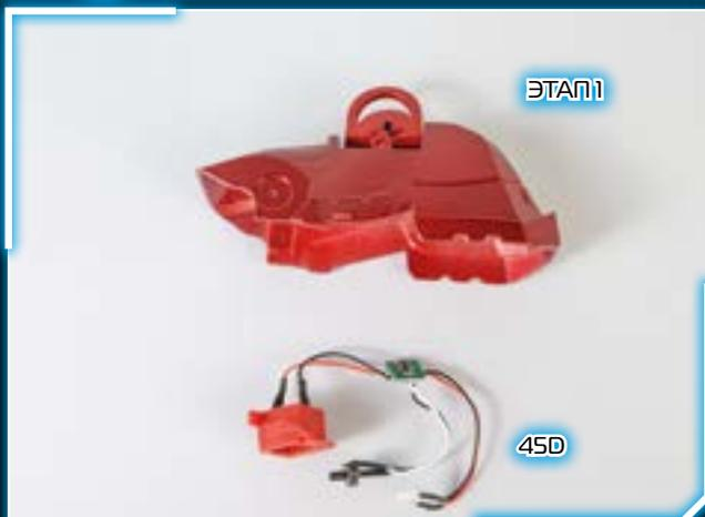
1 - Батарейный отсек (45D), соединенный с выключателем и светодиодом, устанавливается внутри ботинка.
